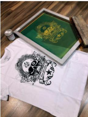
Der Siebdruck ist ein Direktdruckverfahren. Beim Siebdruck werden ohne Transfermittel die Druckfarben direkt auf das Textil aufgetragen, dies geschieht mit Hilfe von Schablonen. Hierzu wird die Farbe mittels eines Rakels über die Schablone geschoben und somit auf das Textil gedruckt. Beim Siebdruck handelt es sich um ein Schablonen-Druckverfahren.
