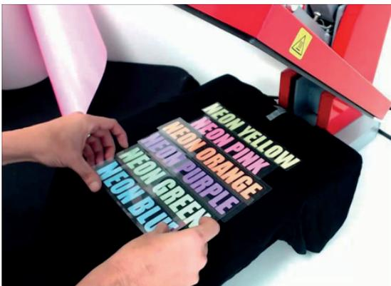
Der Transferdruck ist ein hochwertiges Druckverfahren und kann bei fast allen Textilien angewendet werden. Die Farbe wird nicht direkt auf das Textil, sondern auf eine Folie gedruckt und danach mittels Heisspresse auf das gewünschte Textil aufgepresst.
