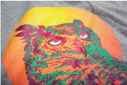
Der digitale Direktdruck zeichnet sich dadurch aus, dass eine spezielle Produktfarbe **direkt** auf die Textilien gesprüht wird. So benötigst Du im Gegensatz zum Transferdruck keine Folie. Bei diesem Druckverfahren können alle Farben, Farbverläufe oder rasterbasierte Grafiken verwendet werden. Außerdem lassen sich eine Vielzahl an farbenfrohen und aufwendigen Motiven realisieren.
